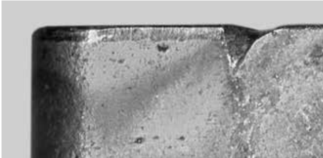
Сужающиеся зарубки при максимальной глубине реза.
